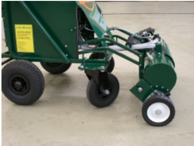
Abb. 1: Fahrgestell mit Luftreifen und Streichwalze mit Keilriemenantrieb.
